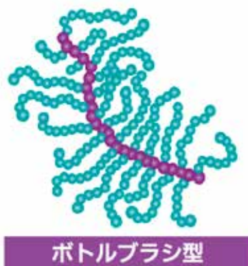
図3 ボトルブラシの構造
