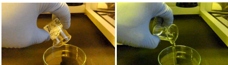
図5 光照射により流動性が変化するハイドロゲル 光源：Hg-Xe Lamp 365 nm 光 (250 mW/cm 2 ) 左：光照射前、右：光照射20分後
